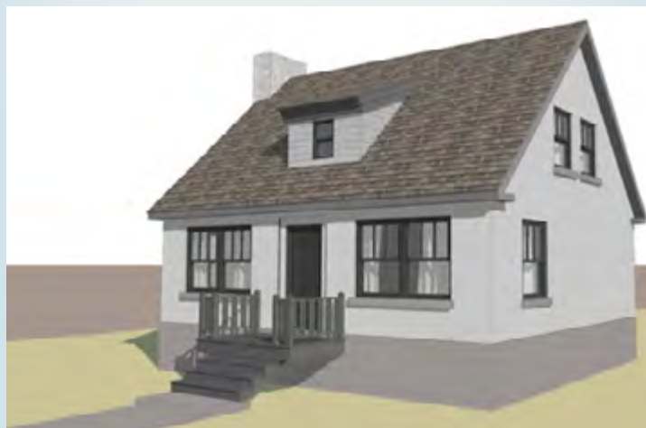
Image : Maison de vétéran construite vers la Seconde Guerre mondiale. Répandu à travers le Québec (surtout à Montréal), ce modèle comporte fréquemment une entrée de service en plomb. / Source : Ville de Montréal
