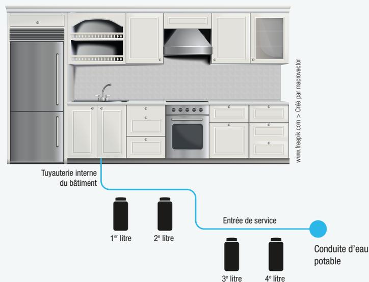
Illustration d'un échantillonnage séquentiel. Le premier litre du prélèvement va dans la bouteille n° 1, le deuxième dans la bouteille n° 2, etc. Ce système permet de déterminer la provenance du plomb.
