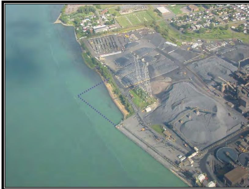
FIGURE 4 : AGRANDISSEMENT PAR REMPLISSAGE DE LA ZONE D'ARRIÈRE-QUAI
