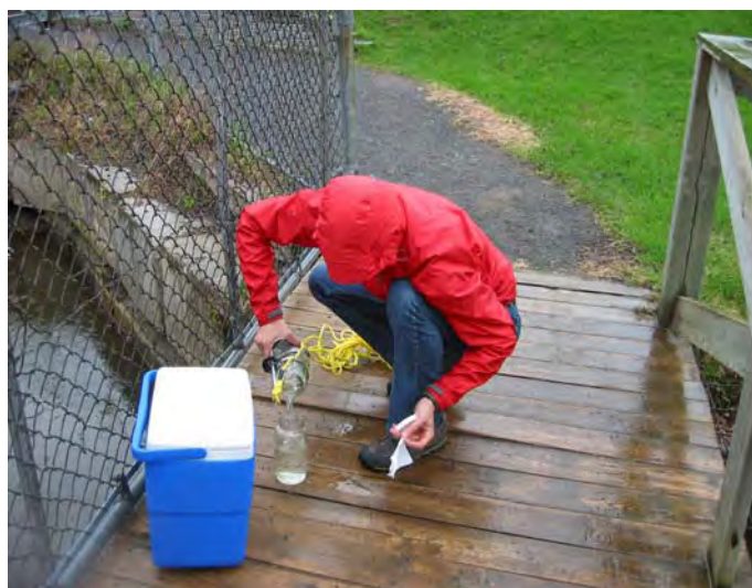
Échantillonnage des eaux de surface pour la mesure des pesticides (photo : I. Giroux, MDDEFP)
